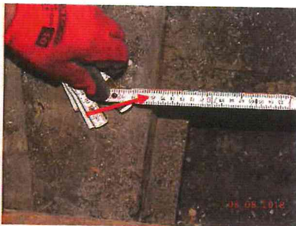
Fot. 10. Pomiar rozstawu osiowego belek: 90 cm
